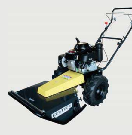
TRT 60 (COD. 042 - 052) - DISBOSCATORE TRINCIATUTTO CON TRAZIONE - DRIVE FORESTRY MOWER
